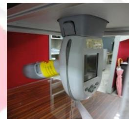
XRF手持式塑膠與合金分析儀
